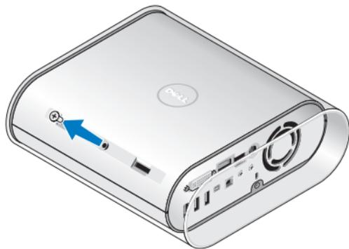
2. 垂直放置计算机并向计算机背面轻轻拉扯套管，然后轻轻将新套管滑入计算机。
